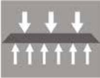
**Trennen ist eine der Hauptaufgaben von Geokunststoffen. Als Trennschicht verhindern Geokunststoffe die Vermischung unterschiedlicher Bodenschichten und das Aufsteigen von Feinanteilen.**
