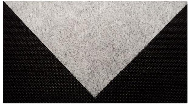
Als Trennlage zwischen Beton und Gussasphalt
